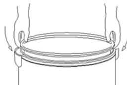
Fechamento: Segurando a tampa pela alça abaixe-a pressionando levemente até sentir que a trava (a mesma do botão de abertura) se fixe completamente no corpo do aparelho completamente no corpo do aparelho.
